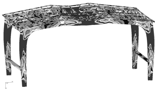
Rys.7. Mapa naprężenia zredukowanego w osłonie ratowniczej indywidualnej – model 9 [4]
