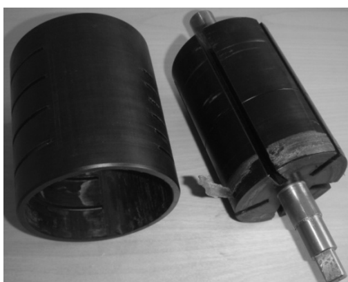
Rys.9. Uszkodzona tuleja cylindra oraz wirnik oklejony materiałem z tulei [3]
