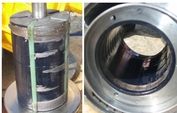
Rys. 13. Oklejony materiałem tuleja cylindra wirnika i uszkodzona tuleja cylindra [3]
