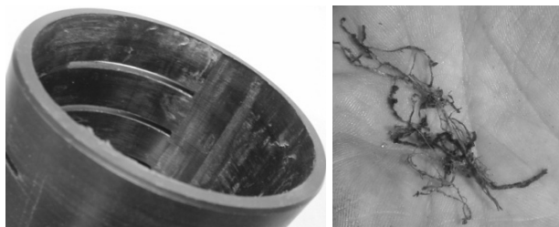
Rys.8. Uszkodzenia tulei cylindra wykonanej z materiału I [3]
