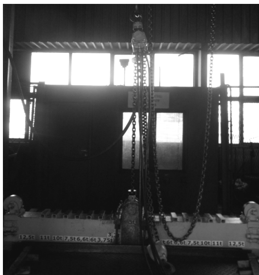
Rys.16. Stanowisko do badań wciągników pod obciążeniem [3]
