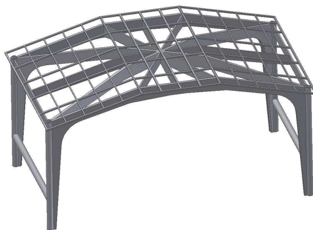
Rys.6. Model geometryczny analizowanej konstrukcji osłony ratowniczej indywidualnej – model 9 [4]
