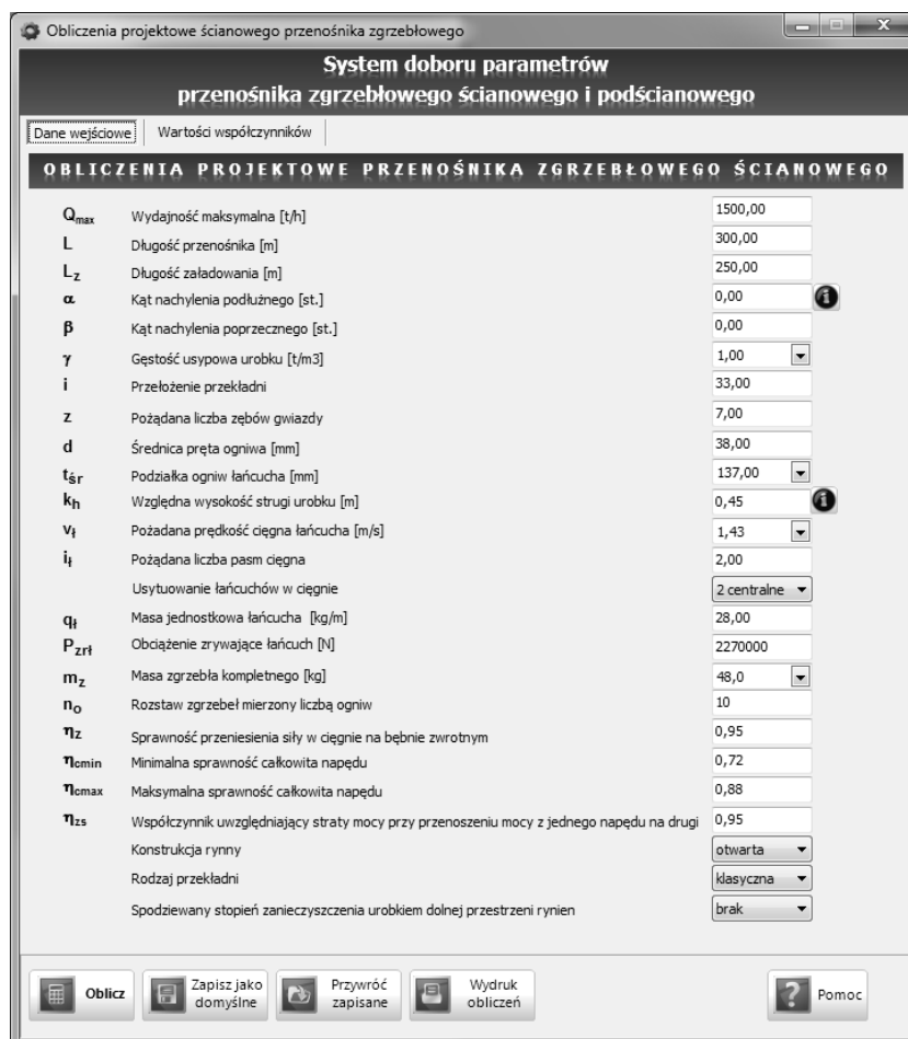
Rys.6. Okno programu - obliczenia projektowe przenośnika zgrzeblowego ścianowego [4]
