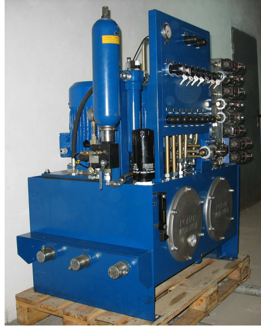
Rys.2. Widok agregatu hydraulicznego zespołu sterowania EL-2
