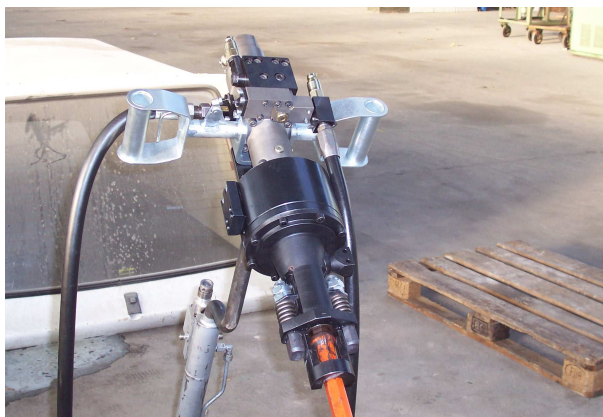
Rys.1. Ręczna wiertarka RWU-50 na stanowisku badawczym
