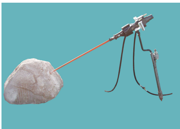
Rys.3. Ręczna wiertarka RWU-50 podczas wiercenia w podłożowym granicie narzutowym
