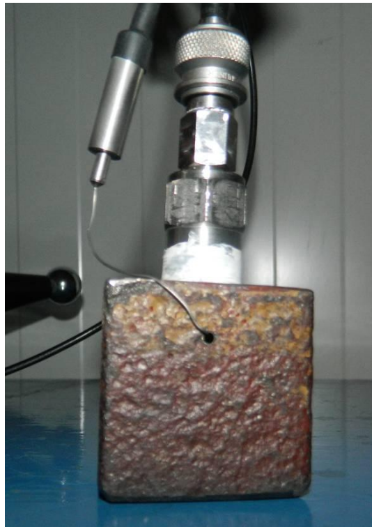
Rys. 7. Widok przetwornika typu A zamontowanego w adapterze [1]
